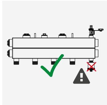
**⚠ AVVERTENZA.** In caso di installazione in verticale o capovolta, la valvola di sfogo aria non deve essere installata; sostituirla con un tappo da 1/2" M.
